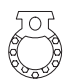
2051 (Material com 2 durezas) (Zona de batente: E.P.D.M. esponjoso) (Base: E.P.D.M. de 70° SHORE) Rolo: 300m (150m+150m)
