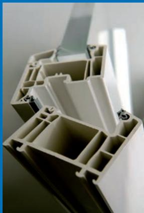
Sistema de perfis de desenho suave e arestas arredondadas para janelas e portas de sacada de batente ou oscilobatentes de **70 mm de profundidade** e **5 câmaras** interiores na folha e aro.
