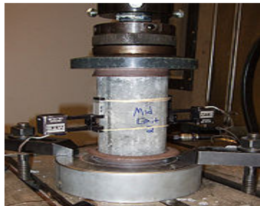
Ensaio de resistência à compressão numa amostra de revestimento
