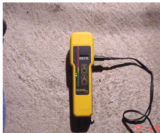
Controlo da humidade do revestimento numa obra
